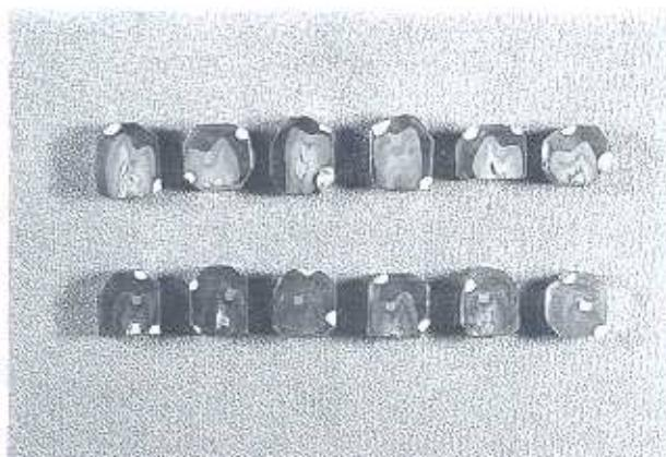
**Resim 2.** SEM incelemesi için kesit alınarak hazırlanan ve altınla kaplanmış ömekler.
