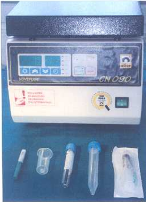
Resim 1. TZP hazırlamak için gerekli santrifüj cihazı. Soldan sağa: iğne, tutucu, sitratlı vakumlu tüp, boş 10 cc tüp, 5'lik enjektör
